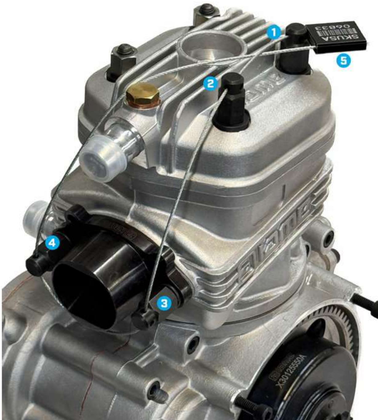
Instalación del sello del motor
